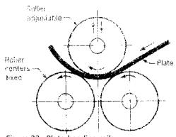
Figure 23 : Plate-bending roils
